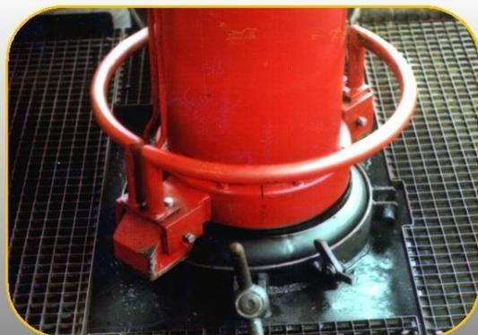
**A) Aufblasbarer Dichtungsbalg (innere Domabdichtung)**
