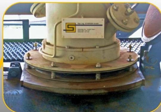
**B) Federnd gelagerte Dichtplatte (äußere Domabdichtung)**
